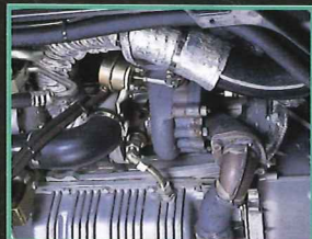
バンパー左側の裏手にはオイルクーラーが増設されている。
