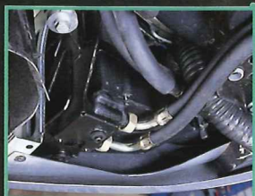
こちらには前側バンク3気筒分を受け持つタービンが見える。
