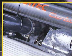
スカッフプレートとの間の狭い空間に押し込められたTツメのタービン。
