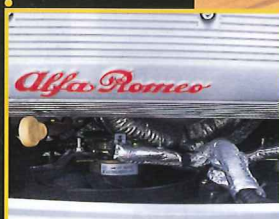
とにかくスペースがギリギリなため遮熱材が到るところに。
