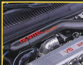
パイピングは膨張を防ぐカーボン製とされ、レスポンスを高める。
