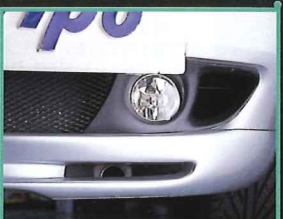
上下のダクトがそれぞれオイルクーラー、後側のタービンに風を導く。
